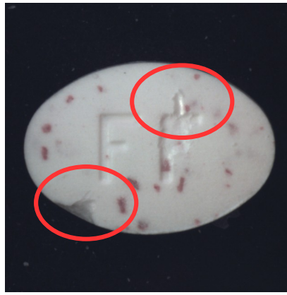
Abplatzung + Schrift beschädigt
